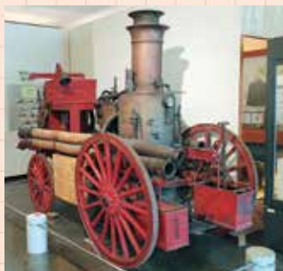
補修前の蒸気ポンプ
